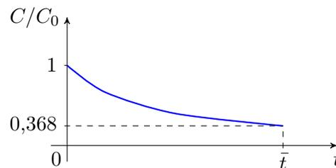
Figura 6: Variação da concentração ao longo do tempo para um reator de mistura completa com marcador instantâneo e conservativo. Após o tempo de retenção a concentração irá cair a zero de forma assintótica no tempo.
