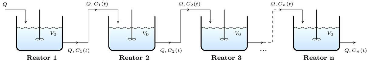
Figura 7: Reatores de mistura completa em série
