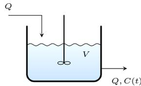
Figura 5: Reator de mistura completa
