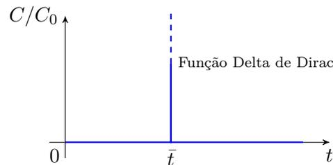
**Figura 4:** Variação da concentração ao longo do tempo para um reator de fluxo pistonado com marcador instantâneo e conservativo
