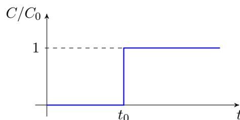
Figura 2: Variação da concentração ao longo do tempo para um reator de batelada com marcador instantâneo e conservativo
