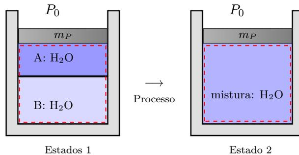
Considerando a massa de água em  $A + B$  como um sistema termodinâmico fechado. A massa da membrana não é contabilizada, pois se fosse deveríamos ter considerado um sistema aberto.
